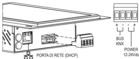
Utilizzare per la connessione del **BUS** il morsetto in dotazione, rispettando la polarità descritta. Effettuare i collegamenti in assenza di tensione.
